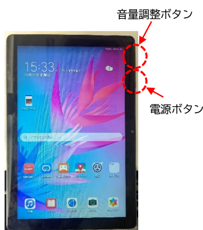
測定用タブレット (測定用ソフトインストール済) 型番 TERRA-TB
