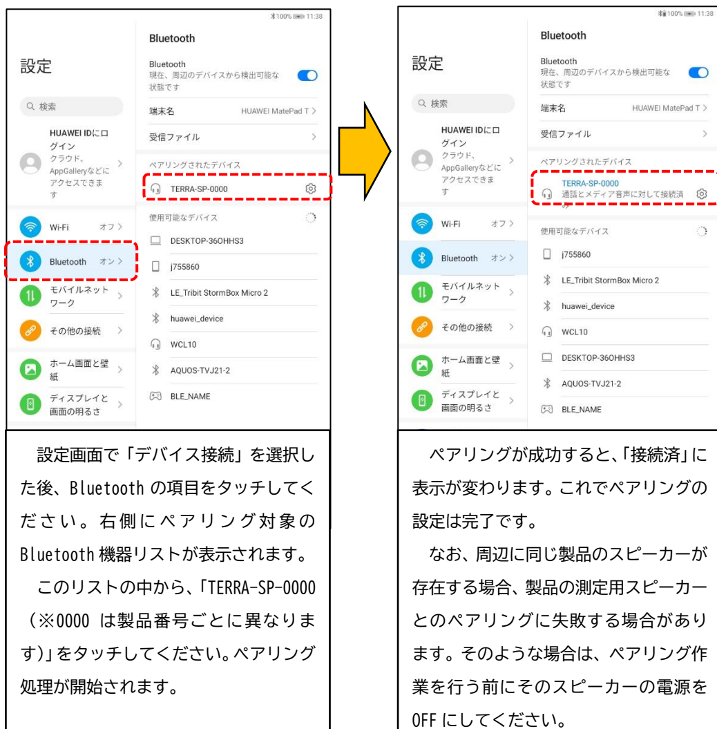
図 4-4 測定用タブレットと測定用スピーカーのペアリング手順
