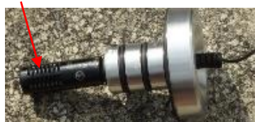
測定用マイク (管口に取付け) 型番 TERRA-MK
